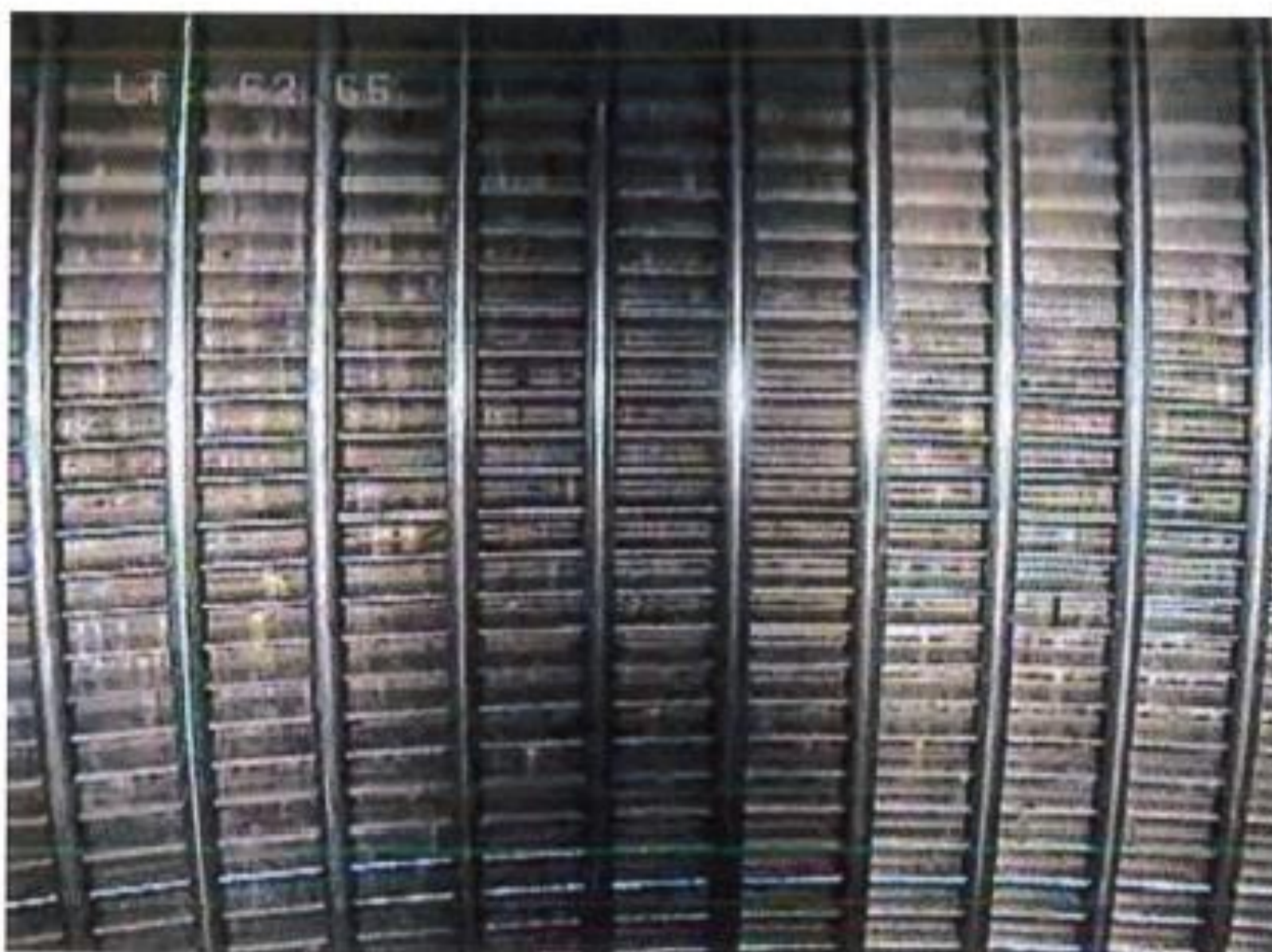
6- Tubage inox plein (62.65 m) – fentes ouvertes, observation du massif filtrant
