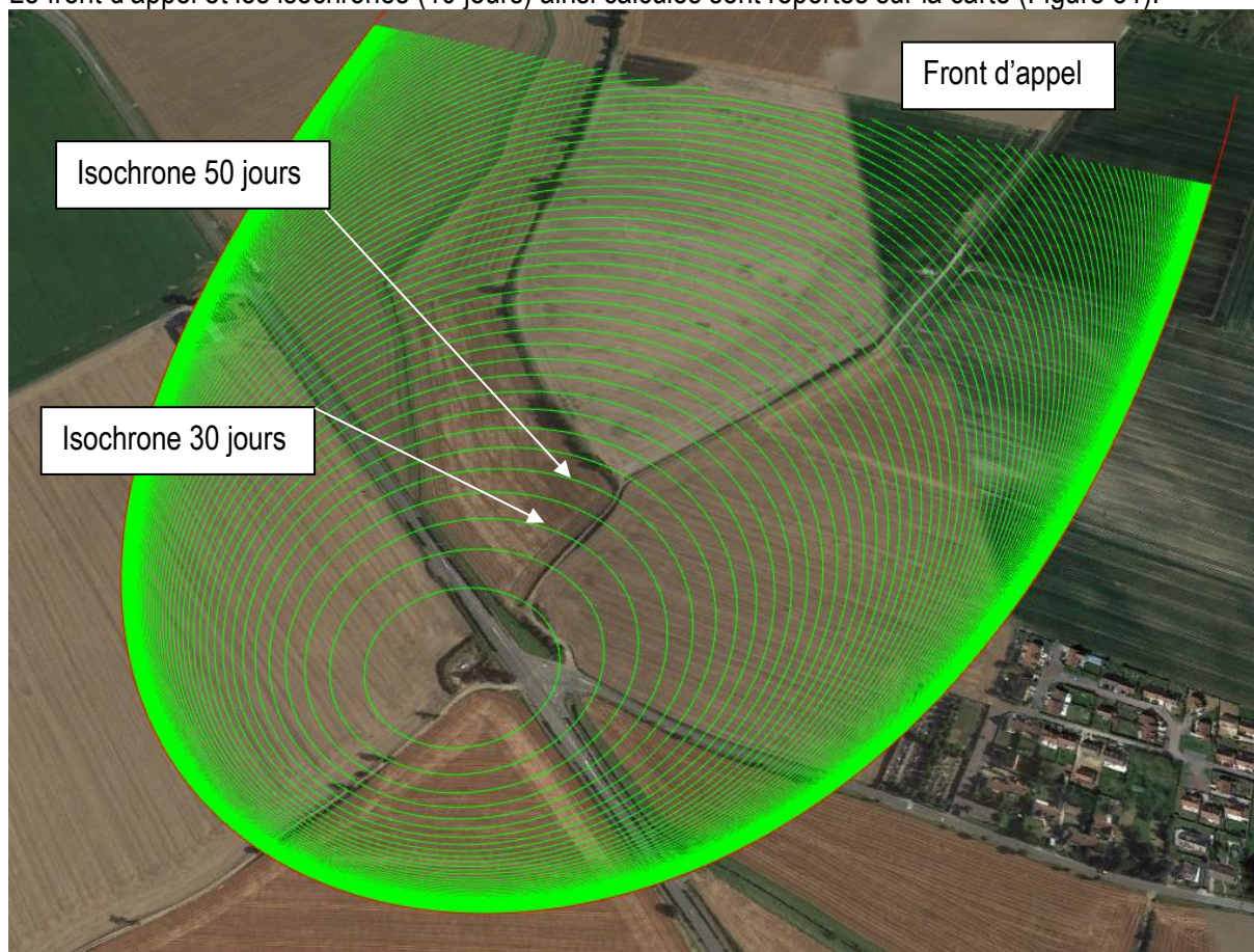
Figure 31 : Front d'appel et isochrones du Forage FM3
